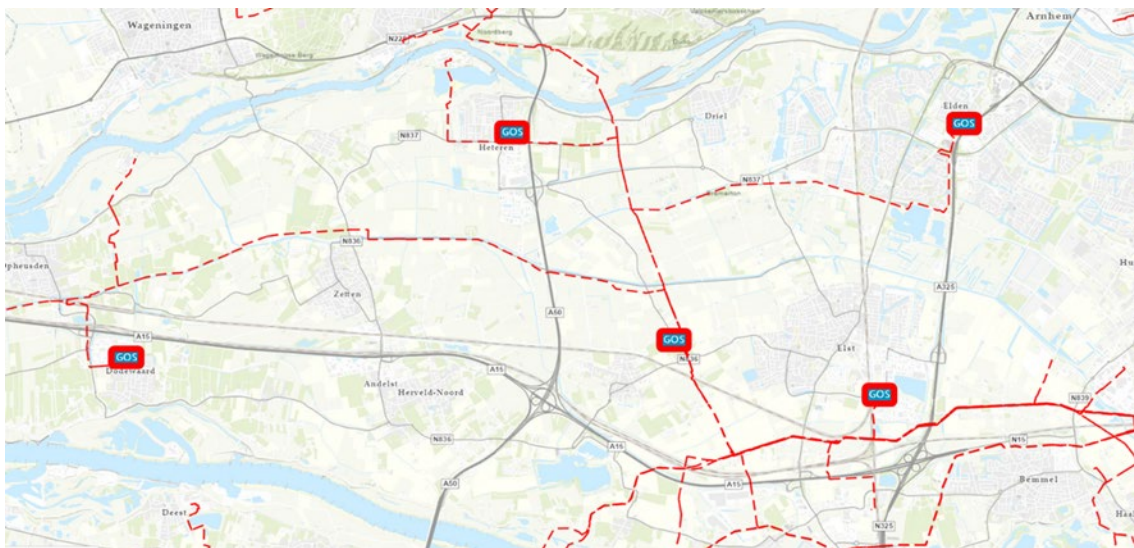
Figuur 69. Gasontvangststations (GOS) en hoe deze vanuit het regionaal transportleidingennet (RTL) en hoofdtransportleidingen netwerk (HTL) worden beleverd.
